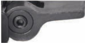
**einstellbare, fixierbare Exzenter-Schnellspannung für werkzeuglosen, einfachen und schnellen Wechsel der Visierungen**
